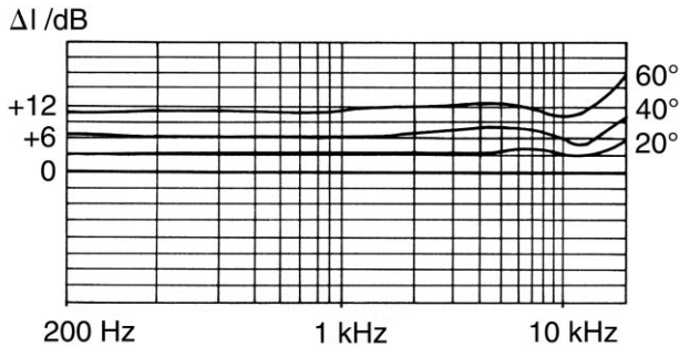
Abb. 2 Weitgehend frequenzunabhängige Pegeldifferenz bei zwei Nieren (MK 4) im Winkel 110^\circ für drei verschiedene Schalleinfallswinkel zur stereofonen Hauptachse ( 20^\circ , 40^\circ , 60^\circ )
